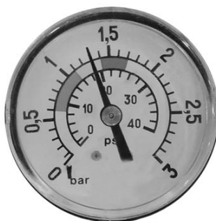
1,3 kg/cm 2 - 18,5 PSI: tlak ve filtru vyžadující provedení PROPLACHU
