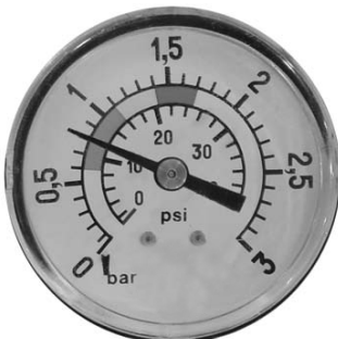
0,8 kg/cm 2 - 11,4 PSI: Normaldruck bei Beginn des Filtriervorganges.
